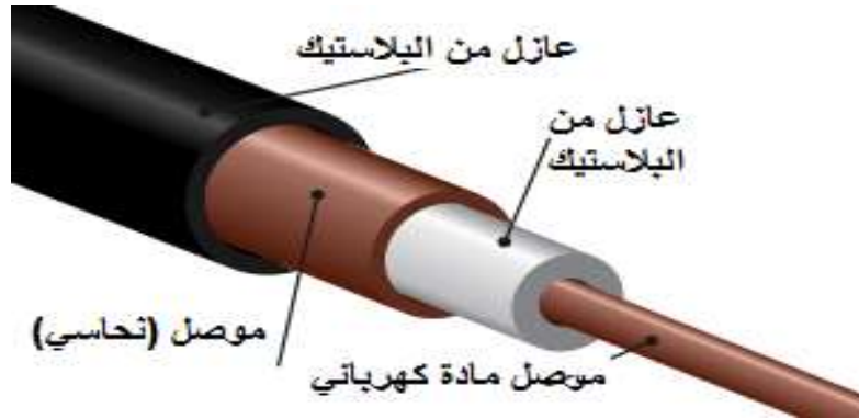
رسم توضيحي 8 Coaxial Cable Structure :
